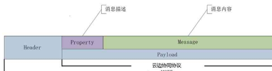
图3 云边协同协议与MQTT的关系
