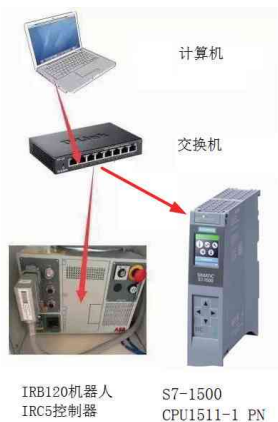
图6 IRB120机器人与S7-1500 PLC的连接
