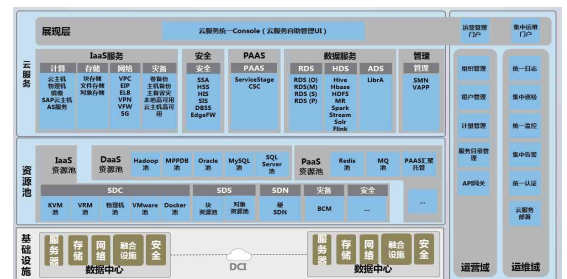
图2 分布式云数据中心总体架构
