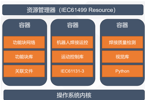
图4 基于IEC 61499的工业边缘计算容器化运行环境
