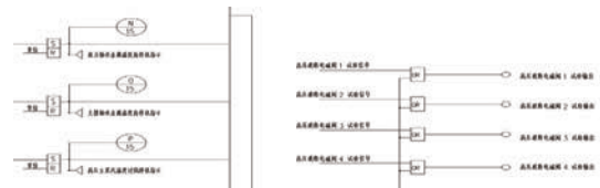
图7 采用正逻辑的ETS跳闸输出逻辑图
