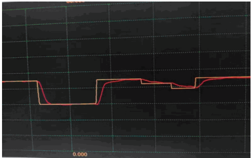
图5 给煤机扰动实验
