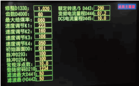
图4 给煤机底层的滤波设计
