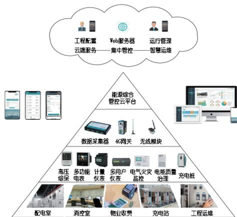
图2 基于仪表的智能配电系统架构
