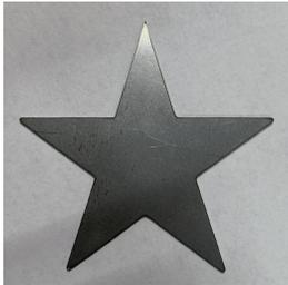
图7a 拐角处样条处理后工件图
