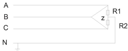
图2 电加热器两相接地短路示意图
