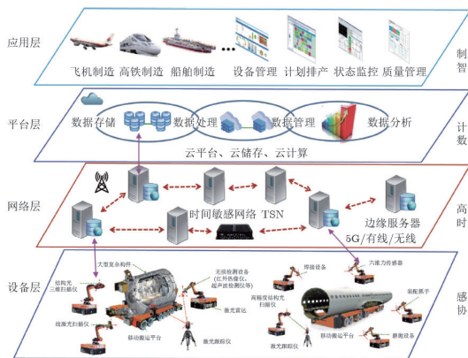
图12 “云-边-端”融合的机器人智能制造模式
