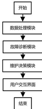
图2 软件系统设计流程
