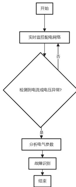
图1 系统操作流程
